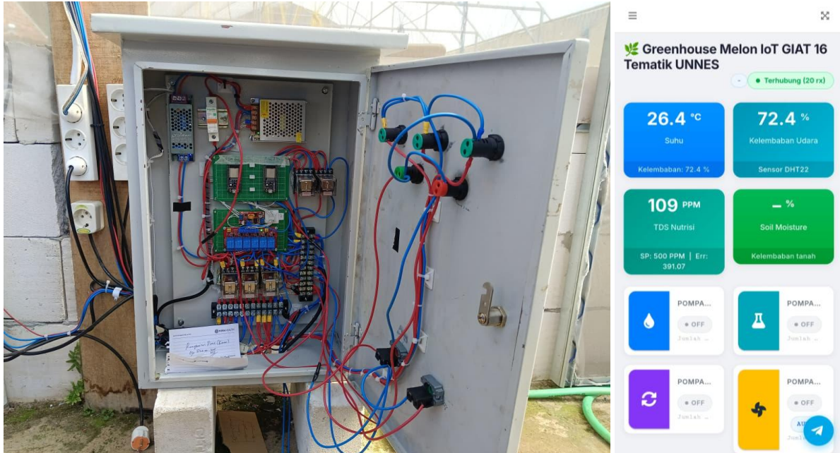
Gambar 3. Implementasi Panel IoT dengan Web Dashboard.
