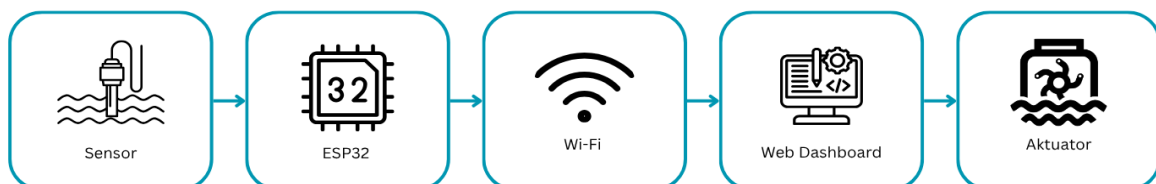
Gambar 2. Arsitektur sistem Smart Greenhouse berbasis IoT
