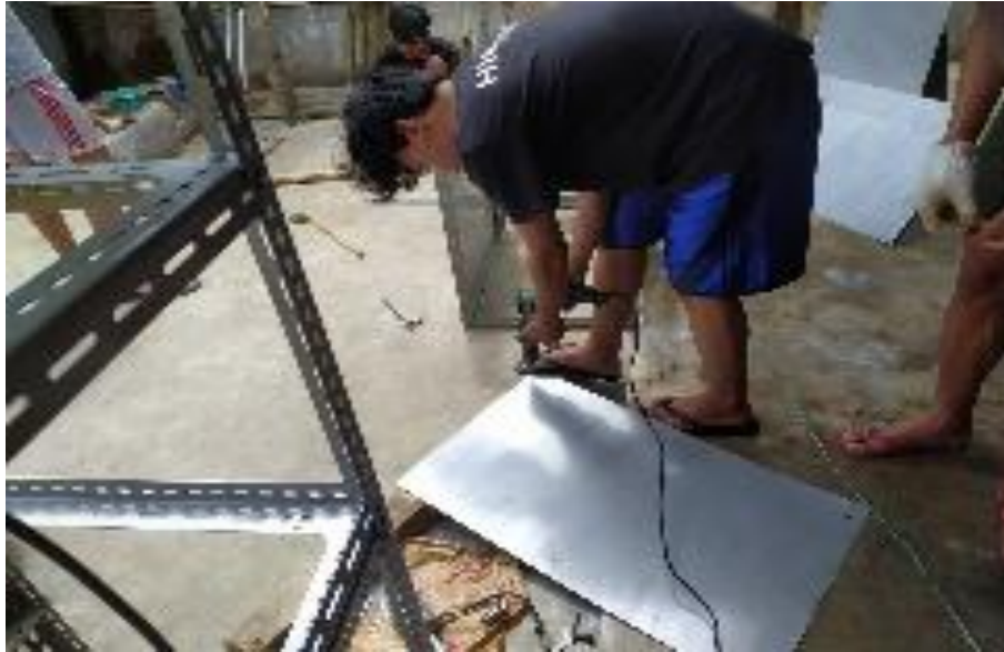
Gambar 5. Pemotongan Sheet Metal untuk Cover Alat Pengusir Hama Burung pada Padi
